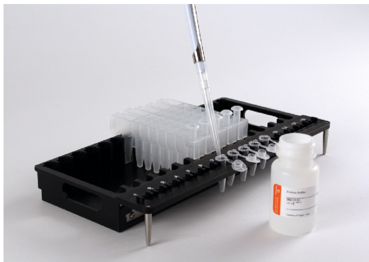
Figure 2. Installation et configuration du plateau. Du tampon d'éluion est ajouté aux tubes d'éluion comme indiqué.
