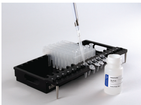
Figure 2. Installation et configuration du plateau. De la Nuclease-Free Water est ajoutée aux tubes d'élution comme indiqué.
