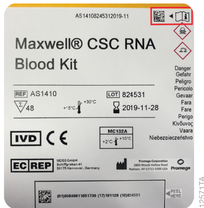
Figure 3. Étiquette de kit indiquant le code barres à scanner. Le code barres à scanner pour lancer un cycle de purification est indiqué dans le rectangle rouge en haut à droite de l'étiquette du kit.
