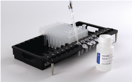
Figure 2. Installation et configuration du plateau. De la Nuclease-Free Water est ajoutée aux tubes d'éluion comme indiqué.
