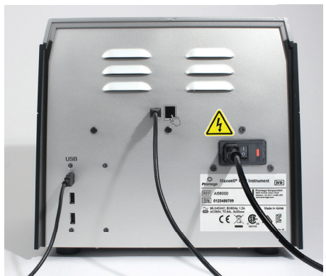
Figure 3. L'appareil Maxwell® CSC vu de dos. Vue de derrière de l'appareil, montrant l'interrupteur de mise en marche, la prise du câble d'alimentation, le port USB de communication entre l'appareil et la tablette, ainsi que trois ports USB supplémentaires pour périphériques (par ex. lecteur de code-barres).
